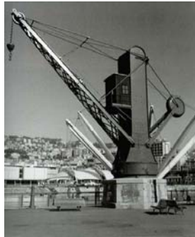
Génova (Italia), Puerto Antiguo. Grúa Hidráulica Tannet & Walker mod. del año 1888 de 10 toneladas de porte.
